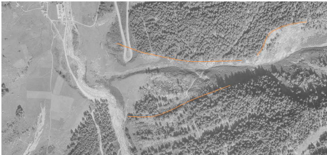
Photo 7. Photo aérienne 25.08.1970. A cette époque, le couloir est plus large ; la limite de la forêt s'étend en dessus de l'épingle de la route cantonale. Un débordement sur la route semble probable. La zone rouge actuelle ne sera donc pas changée à cet endroit (swisstopo).
